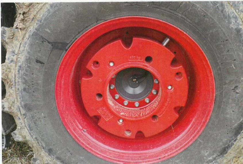
Les masses de 650 kg dans les roues arrière se retirent facilement en ôtant trois boulons.
