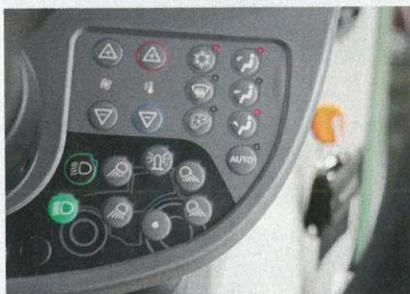
Climatisation automatique et éclairage centralisé sous le tableau de bord.
